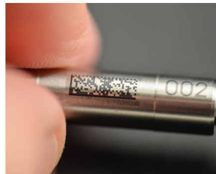
Marquage thermique sur acier inoxydable
