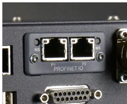
Bus de terrain (Profinet ou Ethernet/IP)
